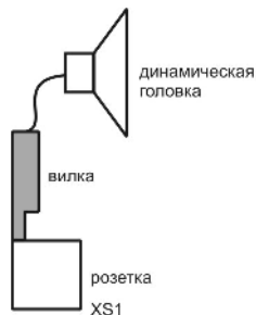
Рис. 2. Подключение динамической головки к плате подключений
